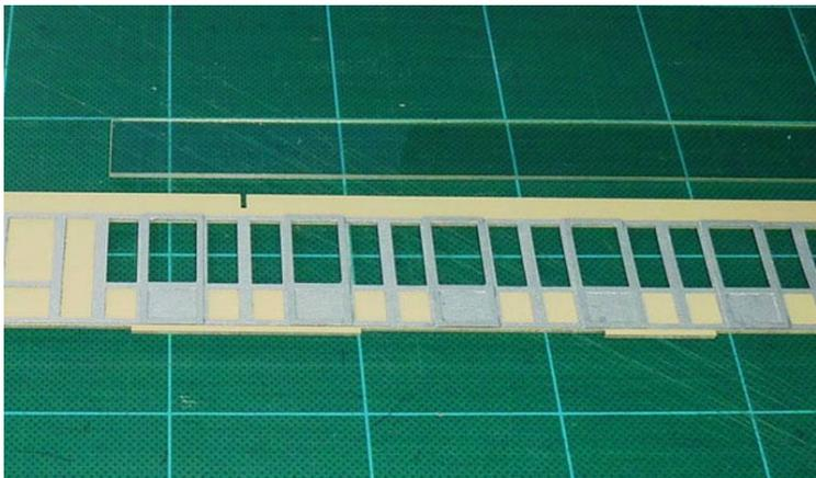
Der Längswand wird umgedreht. Nachdem wird die Klarsichtstreife in dem Spalt des Längewandes eingelegt, (aber nicht geklebt).
