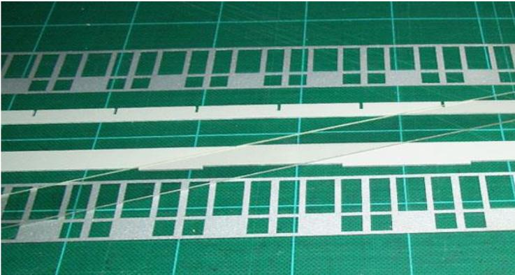
Die Abteil Längswand und die Bodenplatte sind ausgelasert in MDF 1.2 mm. und werden mit Spritzspachtel besprüht.
