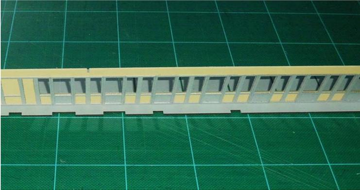
Die Querwände am Wagenende werden vormontiert.
